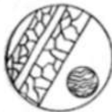
Рис 1. Вид под микроскопом шерстяного волокна в продольном и поперечном разрезе.
