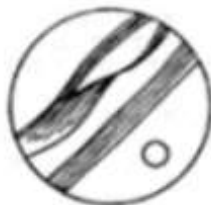
Рис 2. Вид под микроскопом шелкового волокна в продольном и поперечном разрезе.
