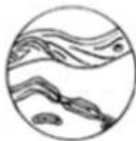
Рис 3. Вид под микроскопом хлопкового волокна в продольном и поперечном разрезе. Технические волокна льна (рис. 4) состоят из пучков элементарных волокон, соединенных срединными пластинками, в состав которых входят пектиновые вещества, лигнин, гемицеллюлозы.
